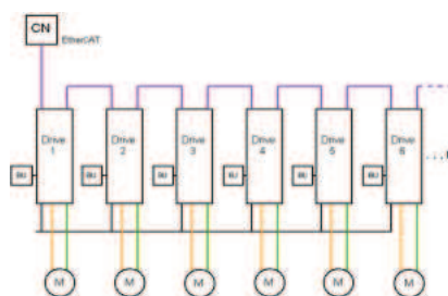
Soluzione tradizionale: un servoazionamento per ciascun asse
